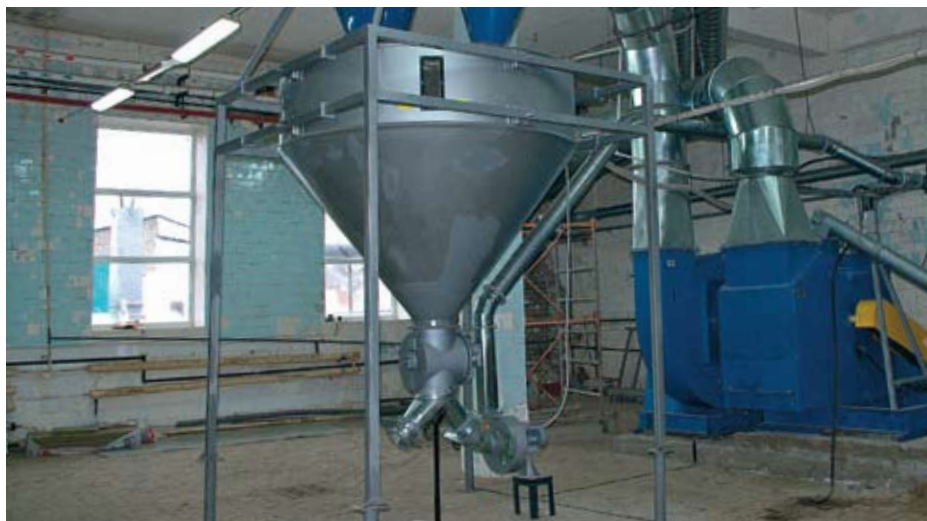
Линия сушки свекловичного жома на основе аэродинамического диспергатора позволила компании «Новая территория» наладить выпуск инновационной пищевой добавки — свекловичной клетчатки
